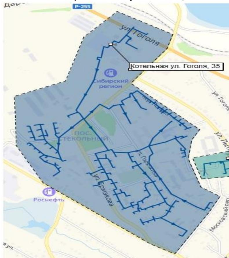
**Рисунок 4 Зона действия котельной (более детально зоны действия источников можно увидеть в электронной модели)**
