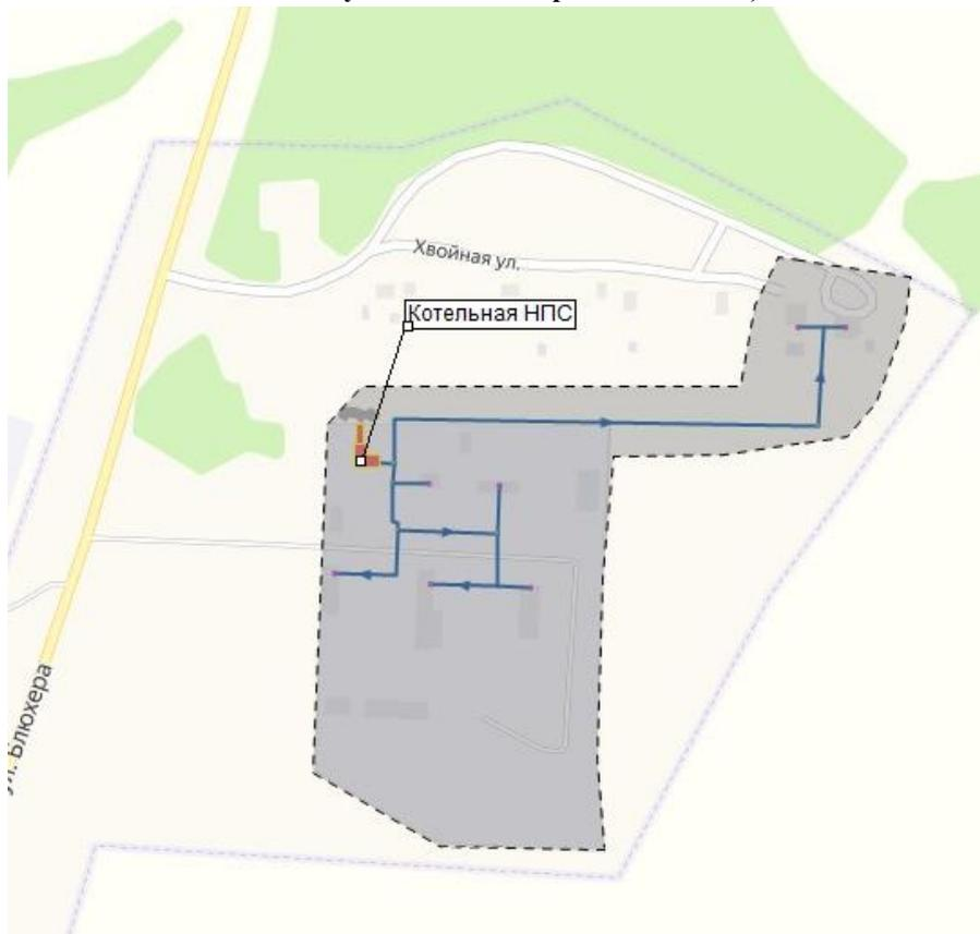
**Рисунок 15 Зона действия котельной (более детально зоны действия источников можно увидеть в электронной модели)**
