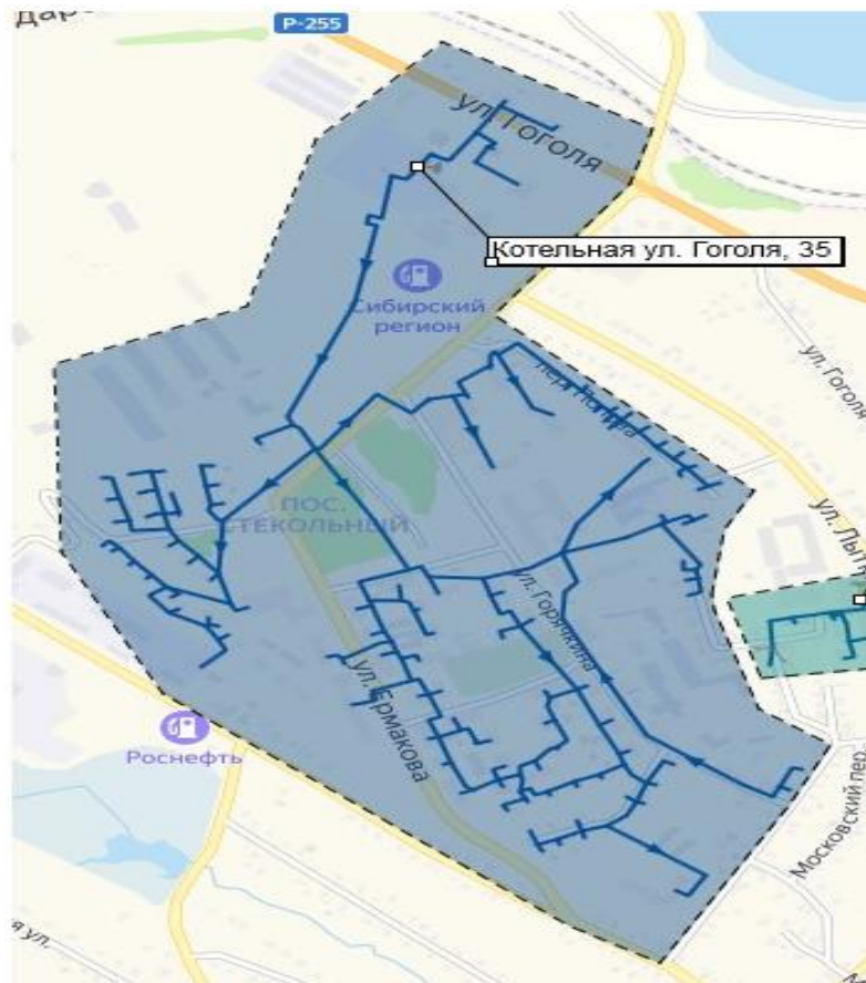
Рисунок 47 Зона действия котельной (более детально зоны действия источников можно увидеть в электронной модели)
