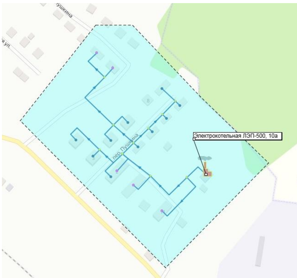
Рисунок 2.1.10. Зона действия котельной
