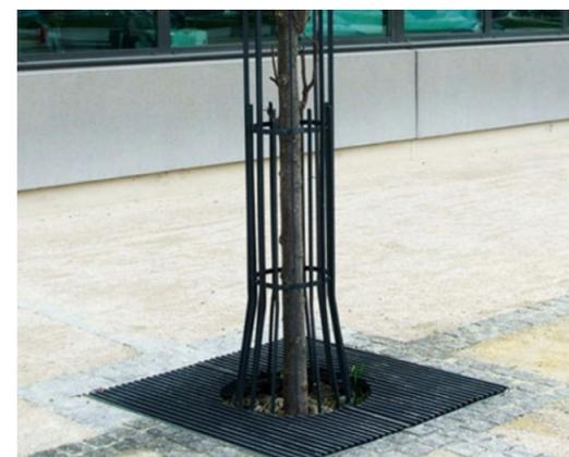
Конструкция цилиндрической формы состоит из стальных прутьев круглого сечения, устанавливается на приствольную решетку.
